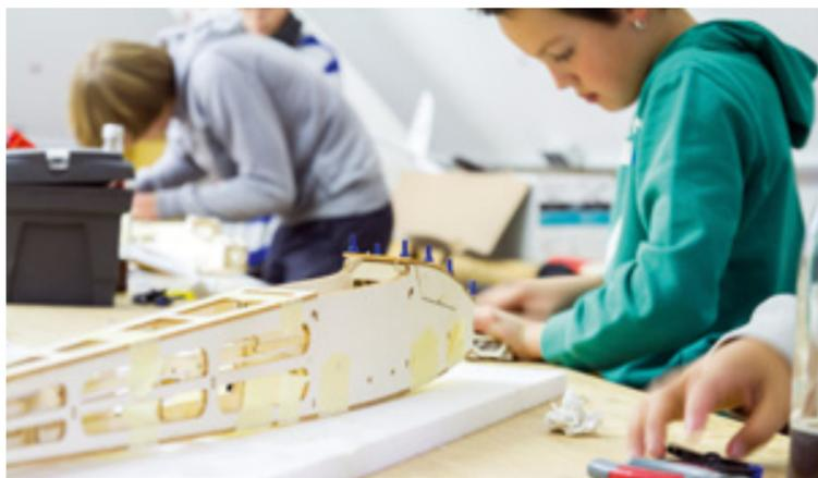
Die Verklebungen des rohbaufertigen Kastenrumpfs müssen trocknen, bevor es mit dem Verschleifen weiter geht
